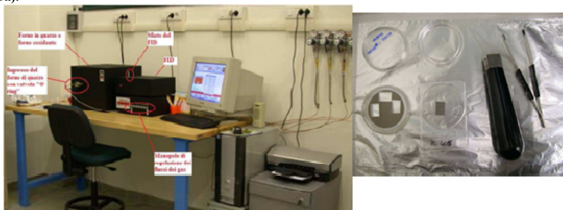
Figura 15: Analizzatore termo-ottico Sunset (foto a sinistra) e filtro in quarzo con sistema di taglio (foto a destra).
