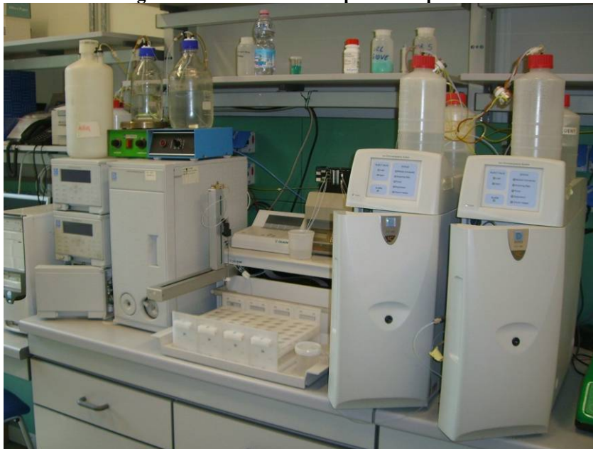
Figura 14: Sistemi cromatografici e relativo autocampionatore per la determinazione degli ioni.
