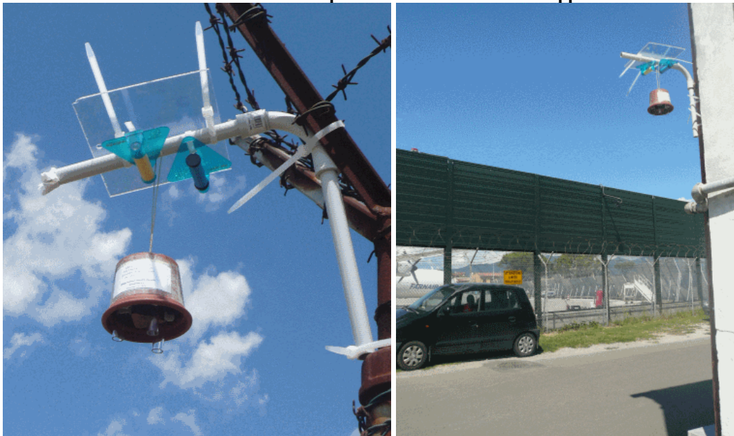
Figura 12: set di dosimetri montati su staffa e protetti da tettoietta e foto rappresentativa di montaggio.
