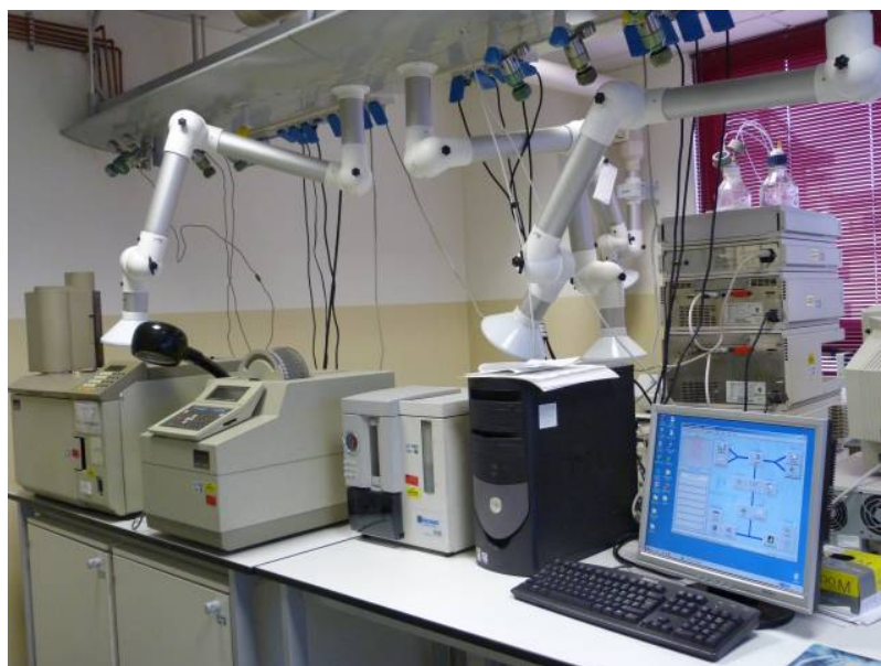
Figura 10: strumentazione ARPAT utilizzata per analisi VOC: GCFID + Desorbitore termico (ATD 400).
