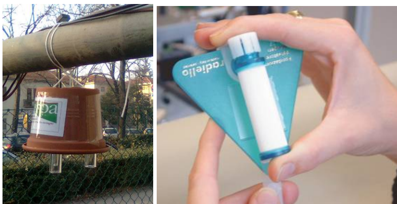
Figura 12: set di dosimetri montati su staffa e protetti da tettoietta e foto rappresentativa di montaggio.
